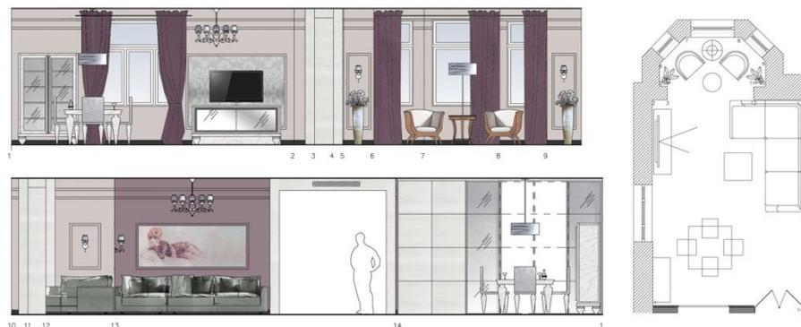
Рисунок 20- Пример развертки по стенам в цветовом решении
