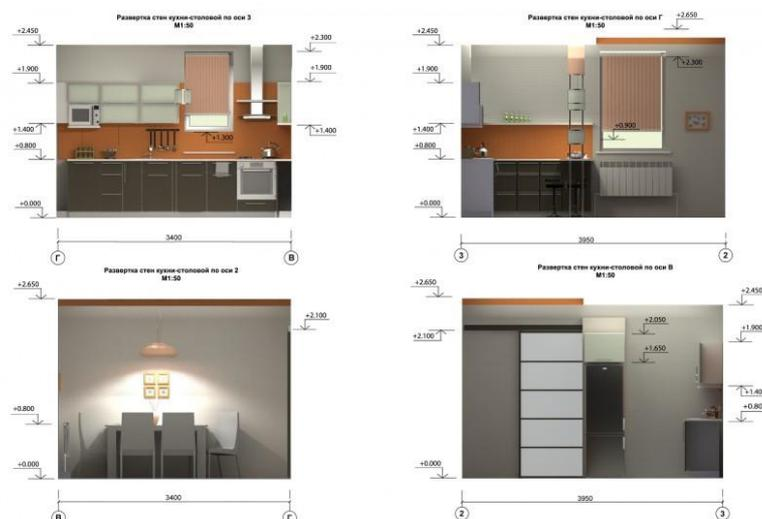
Рисунок 21- Пример развертки по стенам помещения в цветовом решении и выносом высотных размеров и осей
