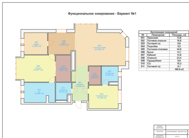
Рисунок 3- Пример схемы функционального зонирования
